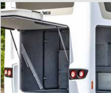
Be- und Entladen der Garage durch verstellbare Heck- und Seitenklappen
