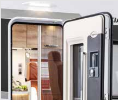
Praktischer Schutz: in der Aufbau­tür integriertes Fliegengitter
