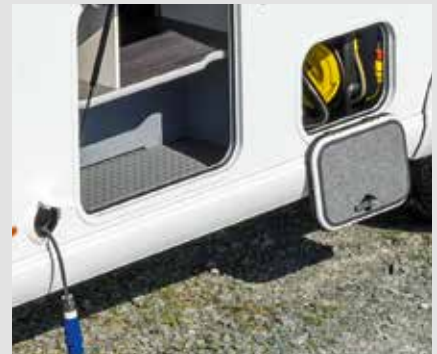
Selbstaufrollende Kabeltrommel mit 15 m Kabel und Zentralversorgung
