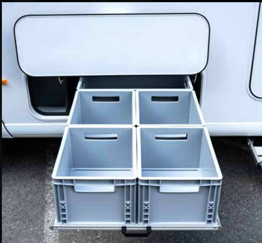
Point fort : grand compartiment de rangement – en option avec ouverture one-touch et système coulissant
