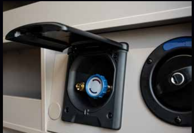
Remplissage d'urgence et raccordement douche extérieure soute arrière
