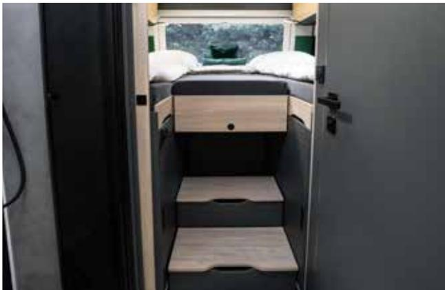
↑ Einfacher Einstieg in die Betten durch neues Stufensystem mit Schienen
