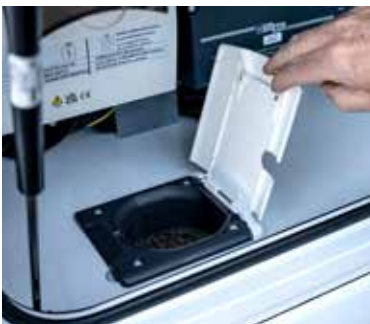
↑ Geschützter Platz für den Stromanschluss
