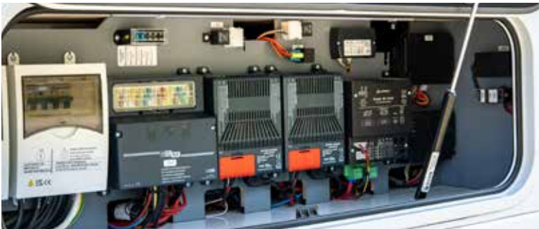
↑ Ordnung 2.0: neues Doppelbodensystem mit separatem Elektronikfach
