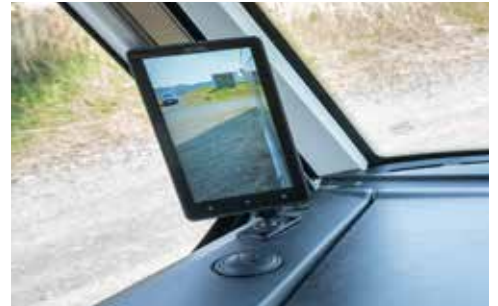
↑ Point fort technologique : au lieu des rétroviseurs extérieurs, un système de remplacement des rétroviseurs est disponible en option, pour encore plus de confort et de sécurité.
