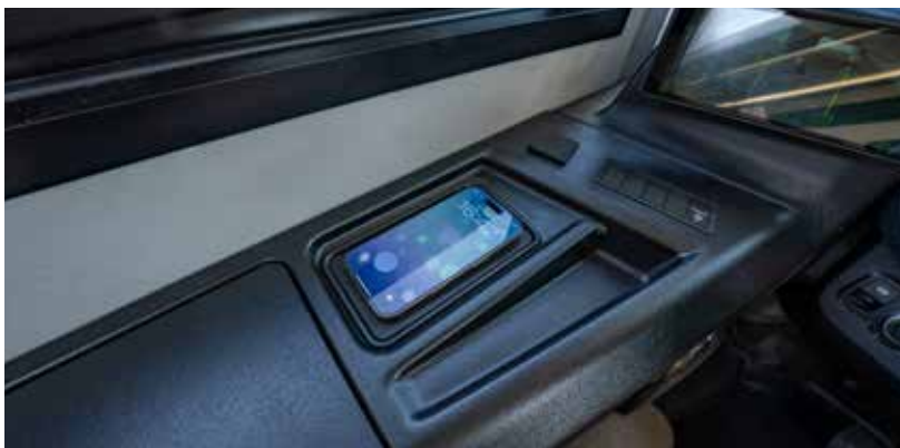
↑ Dans les accoudoirs du conducteur et du passager avant : points de recharge pour smartphones & cie
