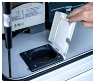
↑ Prise électrique protégée
